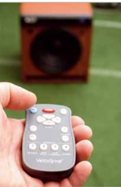
Die kleine Fernbedienung gehört zum Lieferumfang eines jeden Q-Modells: Mit ihr lassen sich Lautstärke, Phase und gleich vier Presets abrufen, die der Besitzer je nach Hörgeschmack abspeichern kann. Anhand der „EQ-Taste“ wird zudem die automatische Einmessung gestartet
